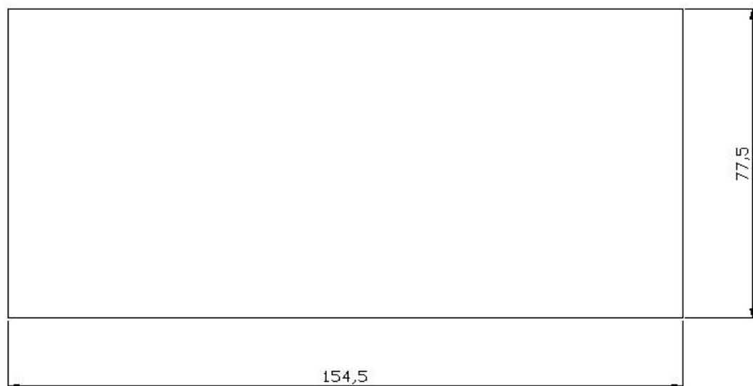
图四 JES-ZBJ-4B-I型 开孔尺寸154.5*77.5 (单位: mm)
